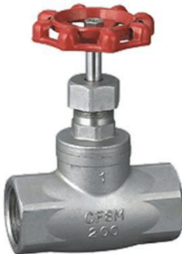
阀杆开启或关闭行程相对较短，并具有非常可靠的切断动作，使得这种阀门适合作为介质的切断或调节及节流使用。缺点1、流体阻波纹管截止阀力大，开启和关闭时所需力较大。2、不适用于带颗粒、粘度较大、易结焦的介质。3、调节性能较差。优点1、双重的密封设计(波纹管+填料)若波纹管失效，阀杆填料也会避免；2、外泄漏，并符合国际密封标准；3、没有流体损失，降低能源损失，提高工厂设备安全；4、使用寿命长，减少维修次数，降低经营成本；5、坚固耐用的波纹管密封设计，保证阀杆的零泄漏，提供无需维护的条件。6、波纹管密封截止阀采用波纹管
